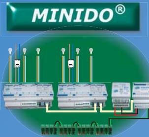
Le câblage évolutif, c'est l'avenir de l'électricité : le lien entre les boutons poussoirs et les lampes/prises n'est plus physique mais se fait par programmation. Le réseau électrique y gagne souplesse et fonctions.
